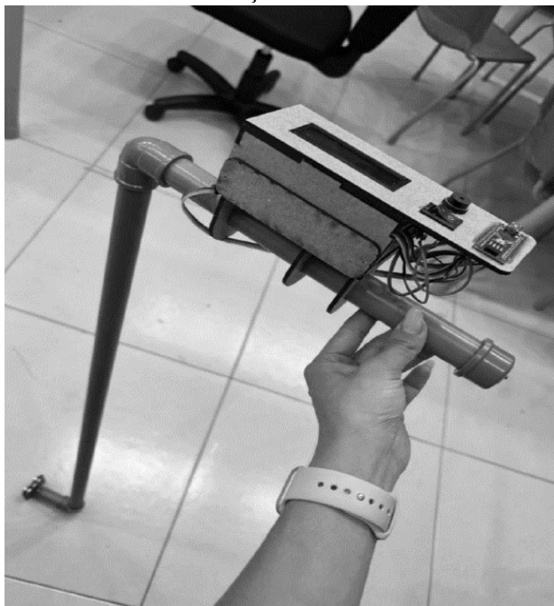
Figura 1: Protótipo da bengala eletrônica desenvolvido para auxílio na locomoção e autonomia.
